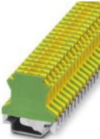
Borne de tierra para carril, tipo de conexión: Conexión por tornillo, número de conexiones: 2, número de polos: 1, sección: 0,2 mm<sup>2</sup> - 4 mm<sup>2</sup>, AWG: 24 - 12, anchura: 6,2 mm, color: amarillo-verde, clase de montaje: NS 35/7,5, NS 35/15, NS 32
