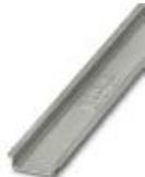
Carril simétrico sin perforar, Perfil estándar, anchura: 35 mm, altura: 7,5 mm, según EN 60715, material: Acero, galvanizado, pasivado de capa gruesa, longitud: 2000 mm, color: plateado
