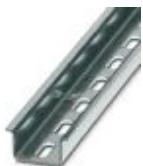
Carril simétrico perforado, Perfil estándar, anchura: 35 mm, altura: 15 mm, similar EN 60715, material: Acero, Galvanizado, pasivado blanco, longitud: 2000 mm, color: plateado
